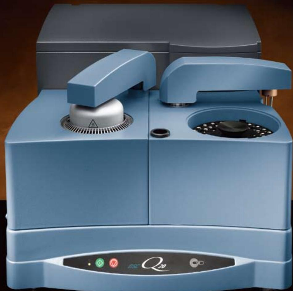
Q20系列(包括Q20、AQ20和Q20P)是一款经济、通用、易操作的DSC, 它的基线性能绝不逊色于许多竞争对手研发级的产品。Q20家族产品稳固、可靠, 是研发、教学和工业中的理想测试工具。AQ20可用于无人照看的多至50个样品的顺序或随机测试。Q20和AQ20均包括双气路数字式质量流量控制器。Q20P可用于压力敏感性材料, 或加热时易产生挥发性成分的材料的研究。
