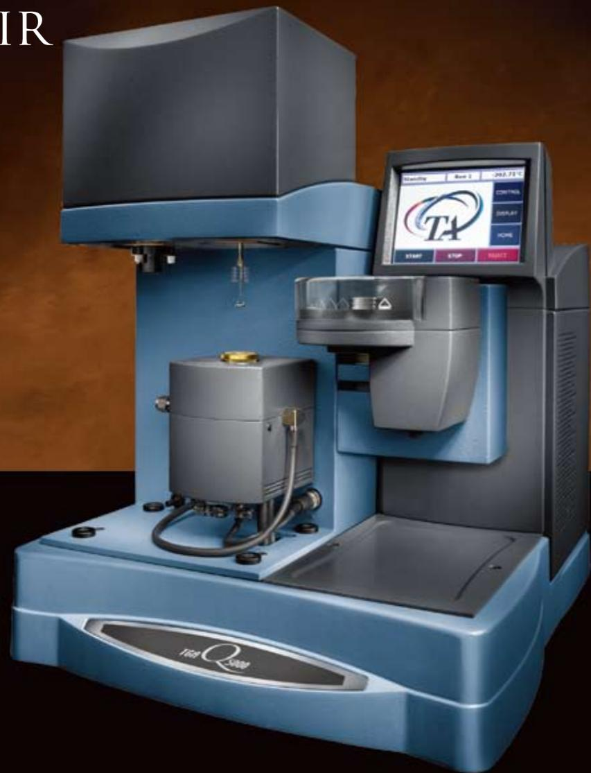
全新高度自动化的Q5000IR，以优异的设计使其适用于各种苛刻的应用需求。Q5000IR具有出众的基线平直度，对微量重量变化具有极高的灵敏度，同时具有标准及高速升温操作的灵活性。其它强大的特点包括：一个集成防污染设计并具有密封盘冲孔能力的25位自动进样器；内置式电磁铁使居里点温度校正异常简便；功能强大的铂金Platinum™软件方便用户规划仪器自动校正、验证和诊断来确保Q5000IR一直处于优异的工作状态下。
