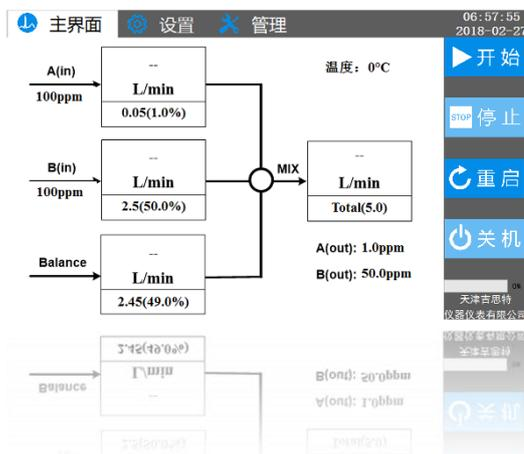
GT-310A 型可编程动态稀释仪是为气体分析、测试类仪器的标定、校准和检测的需求而研发的高科技产品，本仪器能实时配制不同种类、不同浓度的多组份混合气体。使用对象包括环保企业、生物制药、环境监测、煤矿冶金等所有需要混合气体的企业和单位。
