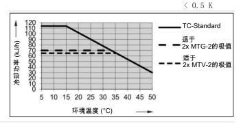
注释:换热器MTV-2和MTG-2的极限曲线适用于50°C的露点下。
