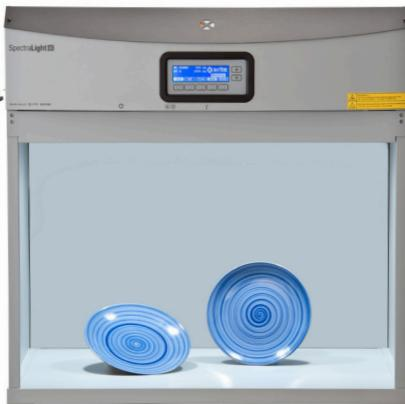
SpectraLight QC 所采用的照明技术优于市场上的任何光源箱。由于本仪器具有的光源数量较多 — 包括日光、白炽光 “A”、水平日光、三种荧光 (CWF、U30、U35、TL83 和 TL84 之间的任何组合) 和 UVa，数量超过任何其他产品，因而可以应用于任何规格。集成光传感器提供荧光灯照度的实时数字输出，并可以通过操作员设置以满足行业标准，如 ASTM 和 AATCC。仪器的闭环荧光灯控制使得操作员可以从一个光源移动到下一个光源，而无需等待需要的预热时间。相同的传感器和电子产品，确保实时控制所有的荧光灯，保持灯泡整个使用期间的精确照度。SpectraLight QC 还提供出厂校准的紫外线，使用户能够根据样品需求（基于应用）调整紫外线量。
