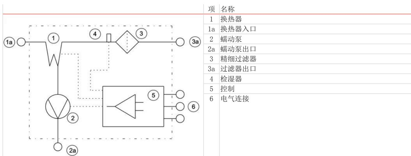
待处理的气体被直接输送至换热器（1，1a）入口中。换热器的出口已与一精细过滤器（3）相连。直接从过滤器的出口，样气借助于软管接头（3a）被继续输送。
