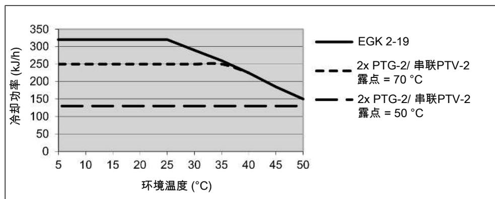
注释：换热器的极限曲线适用于70 °C的露点时且在标准状态下根据EN15267-3:2008-03且在50 °C的露点时在使用条件下。
