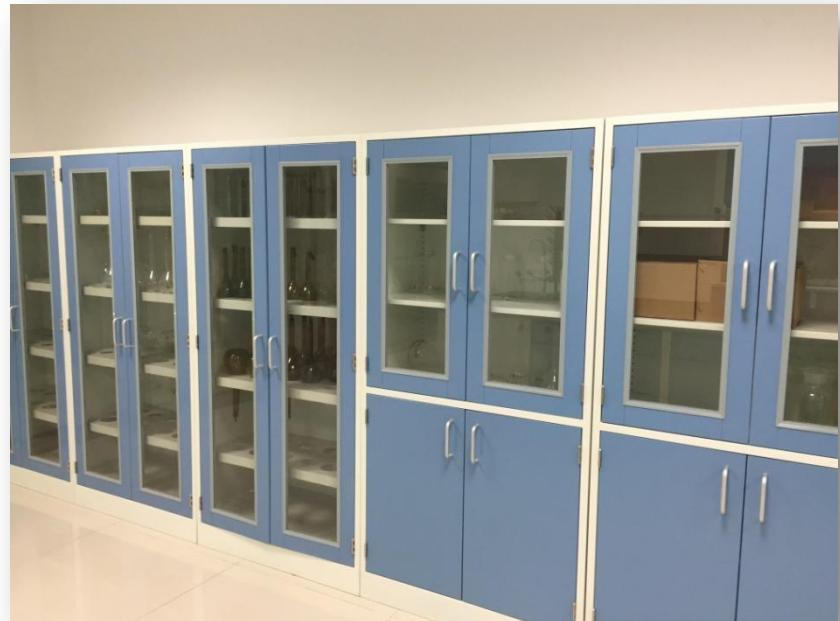
全钢试剂柜又称全钢药品柜，柜体结构采用厚 1.2mm 的冷轧钢板模压成型，所有柜体表面均经过 EPOXY RESIN 粉末静电喷涂处理，具有抗酸碱、防化、防潮、耐高温以及耐磨，柜体中隔板由四个钢制层板扣支撑，高度可任意调节，13mm 可上下移动，承重为 30kg。
