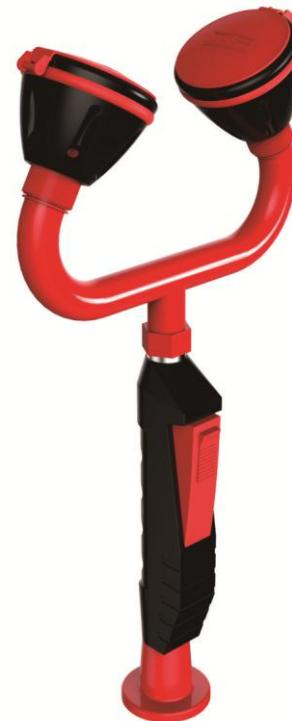
实验室专用洗眼器高亮度环氧树脂涂层、耐腐蚀、耐热、防紫外线辐射。 喷淋头：软性橡胶，出水轻缓压处理呈泡状水柱，防止冲伤眼睛。 金属环扣：具锁定水流功能，方便使用。 控水阀：加厚铜质，高密度 PP 手把，其闭门可自动关闭。
