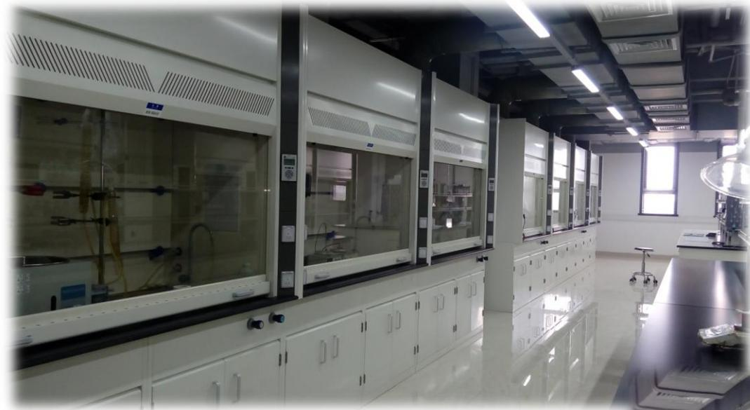
流板，电路控制触摸开关，电源插座等，透视窗采用钢化玻璃，供人操作；下柜采用实验边台样式，上面有台面，下面是柜体，台面可安装小水杯和龙头；其台面是直接与操作者接触的地方，可选实芯理化板，环氧树脂板，不锈钢板，陶瓷等材料。
