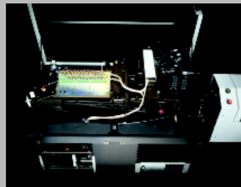
一米聚焦长度的温控光谱室
