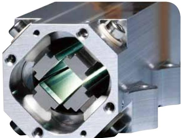
QCell 所使用的 Flatapole 只需较小的池体积，因此缩短了加气时间和排气时间，相应增加了样品测试通量。当加入氦等惰性气体时，Flatapole 能为所有样品类型提供强大的抗干扰能力，从而可以获得一个简单的 ICPMS 谱图。在氦 QCell KED 模式下，iCAP™ Q ICP-MS 具有足够的灵敏度，能够提供低质量元素（锂、铍、硼等）的 ppt 级检出限。因此，iCAP™ Q 能够胜任环境、临床和食品应用中，常规样品的全质量范围分析。
