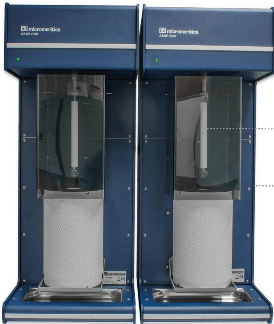
不锈钢歧管提供最优的内部体积和卓越的真空性能, 以确保吸附气体体积的高精确度
