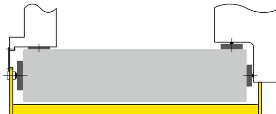
由于Y轴所有导向面均为易于加工的石平台, 因此, 可获得长期稳定的高精度导向面
