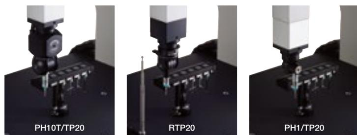
支持最大300mm加长机构的自动摆动头。水平转角 $\pm 180^\circ$ ，垂直旋转 $0 \sim +105^\circ$ ，以 $7.5^\circ$ 间距转动。
