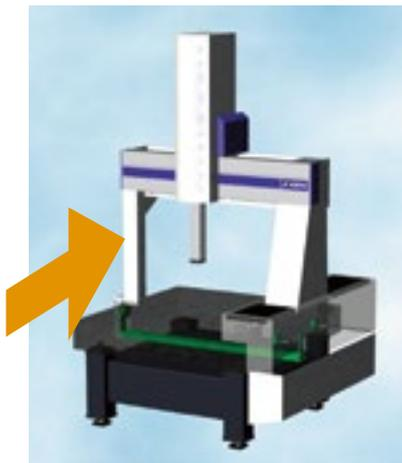
一般情况下, Y轴的导向面会在石平台右侧再设置1个导向面(副导轨)。复式架桥结构通过将石平台的两侧都作为导向面, 可防止副导轨连接处(螺丝、粘着等)的老化, 从而长期保证稳定的精度。结构简单, 也提高刚性。同时, 由于导向面易于加工, 因此, 可实现高精度。
