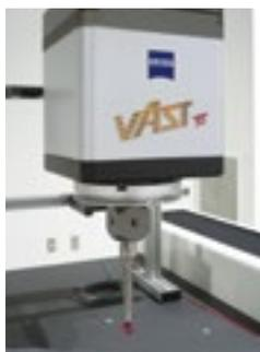
VAST 测针头兼具点对点测量与高速扫描测量这 2 项探测技术。不仅可以用于尺寸测量，还可同一测量机上进行形状检查和位置检查。
