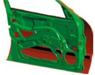
HOLOS-NT 还可在 1 个软件上对车门整体那样难度大的测量对象进行测量。HOLOS Geo 可对标准几何元素进行测量，而 HOLOS Light 和 Extended 可对复杂的自由曲面进行测量，覆盖所有的测量对象。
