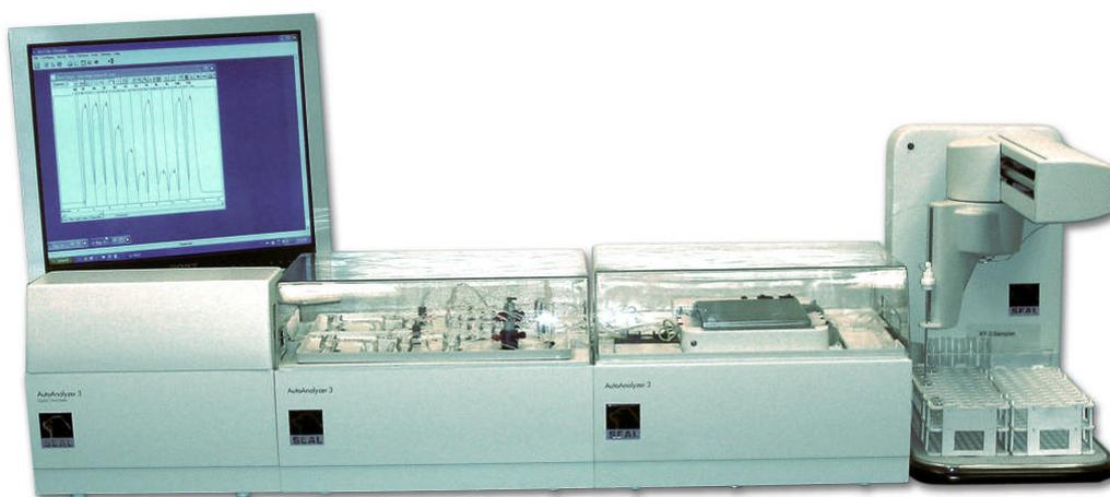
两通道 AutoAnalyzer 3 配上 XY-2 随机自动进样器和多功能化学分析模块分析水和污水等样品中的 18 种参数
