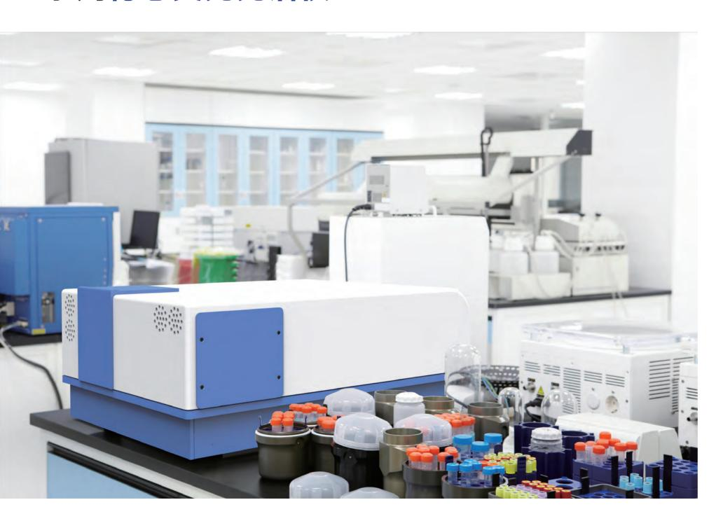
SmartFluo-QY 是卓立汉光公司第一台基于单光子计数技术的一体式稳 态荧光光谱仪。SmartFluo-QY 经过了卓立汉光近 20 年的光学系统优化 设计,并采用了"单光子计数器"作为数据采集装置,具备了对极微弱 荧光信号的探测能力,通过纯水拉曼测试信噪比可达到3000:1以上。 SmartFluo-QY 可以实现宽光谱探测范围,能够满足包括物理、化学、 生物学、医学、半导体材料学、环境学等各种科研及工业应用的荧光测 量要求。
