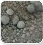
**LOI测试(烧失量)**的测定对无机材料来说是非常重要的。测试中样品快速加热到指定温度,在样品几乎没有变性的情况下迅速测定挥发分。LOI (1000°C) 测试前会做残留水分的测试 (105°C) 1g样品测定两个参数的分析时间为70分钟。
