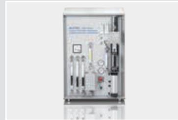
**ONH-2000**用于快速测定钢、铸铁、铝、镍、铜、锆、钛、陶瓷等无机样品中的氧、氮和氢。
