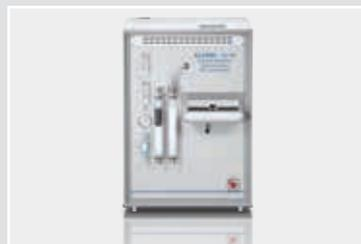
**CHS-580**适用于快速检测有机样品的碳、氢和硫元素含量（比如：煤、碳、矿石、矿物质以及炉渣等）。
