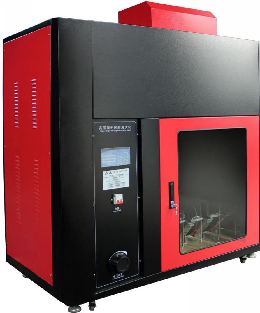
ZLD-6000V 高压漏电起痕试验机主要用于评定户外用绝缘材料（热固性、热塑性模塑料、层压板材、硅橡胶和二元乙丙橡胶等）在严酷条件下的耐电痕化和蚀损程度。此漏电起痕测试仪严格按照 GB/T 6553-2003 《评定在严酷环境下使用的电气绝缘材料耐电痕化
