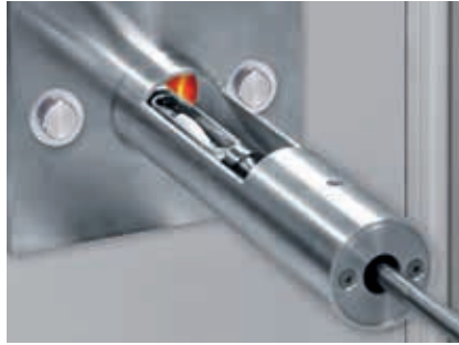
手动将加样头内的样品送到炉内
