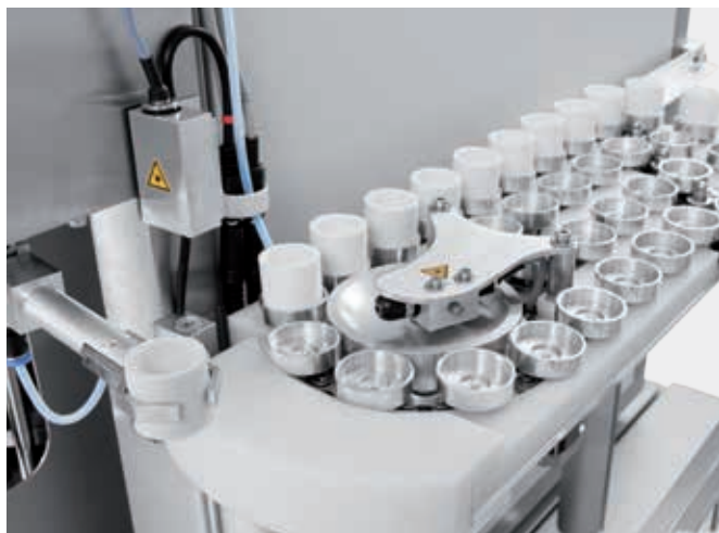
可装载36个样品的自动进样装置
