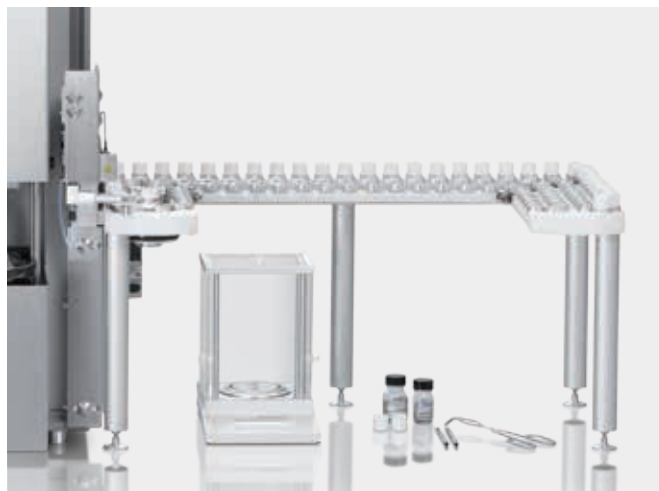
可装载130个样品的自动进样装置
