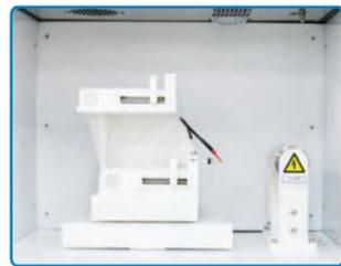
**排风装置**-风速可调，排出实验中挥发溶剂，维持内仓环境稳定，保证实验人员安全。
