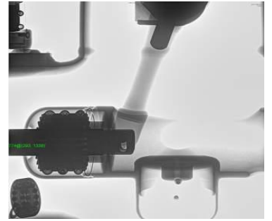
GIS 设备内部结构与 X 射线成像图
