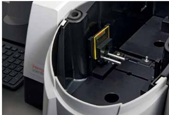
固体样品滑动式支架将提供的附件定位在标准 2 × 3 英寸滑轨上。图中所示仪器带有通用样品架和可选的第二滑动式支架。
