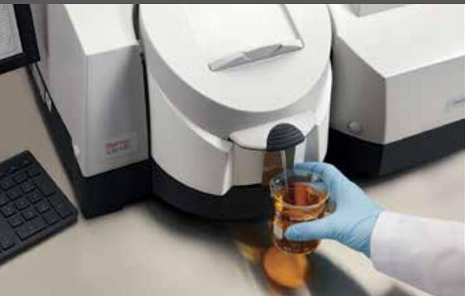
Evolution 350 紫外可见分光光度计支持智能附件，具有自动智能化功能。所有配置都允许电动附件的热插拔，并且在安装时自动识别和初始化每个附件。将附件卡入到位，并在屏幕上显示该附件的相应软件菜单。未使用的附件软件菜单将被隐藏，避免混淆。
