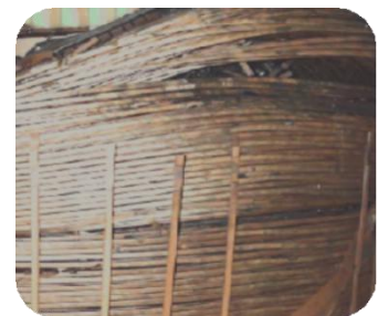
由腐蚀性硫导致的变压器绕组严重电气故障
