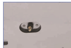
传感器保护装置，保护天平在运输过程中传感器不至于损坏
