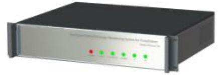
PDMAXX-T 型变压器局部放电 UHF 在线监测装置采集单元单通道采样率最高可达 100M/S，具有极强的信号捕捉能力。可独立安装在被监测变压器附近，周期性地对被监测变压器进行扫描，捕捉设备中发生的各类放电的原始信号。针对变压器内局部放电频谱宽的特性，采用多通道同时采集方式，并兼容不同类型局部放电传感器。通过多路通道信号的采集、滤波、对比，确保检测数据的真实、完整、可靠，最大限度地减少和消除干扰信号。
