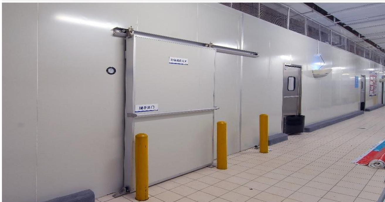
步入式药品稳定性试验箱是以科学的方法创造一个对批量药品失效评测需长时间稳定的温度、湿度环境和光照环境，适用于制药企业对药品及新药的加速试验、长期试验、高湿试验，是制药企业进行大批量药品储藏和稳定性试验的最佳选择方案，方便大批量药品进行长期耐潮湿循环试验。
