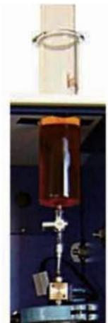
装满油样密封注射器
