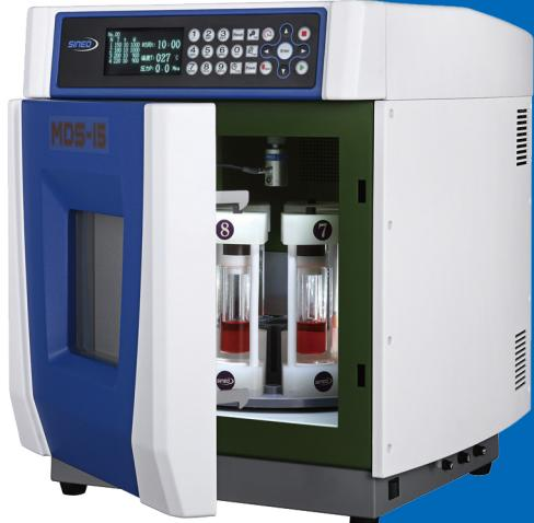
MDS-15密闭式高通量微波消解/萃取工作站，结合16位高通GP-100消解罐，能进行250°C / 6Mpa以内的长时间消解工作，满足绝大部分消解需求；公司研发的8位QZ-100石英消解罐，更将消解能力提升至270°C / 6Mpa，即使最苛刻的材料也可成功消解。配合石英消解罐的远程WiFi视频监控系统让消解过程一目了然，全程可照相和摄像。8位LV-500消解罐组合，一次可有8个500ml超大罐体同时解，将样品取样量提升至无可比拟的10克数量级。全罐磁力搅拌，样品消解更快速彻底。创新的安全泄压片（Safety Bolt）专利设计，能保证安全定向定量泻压与完全消解相结合。各类高取样量消解需求迎刃而解。F-DRY干燥器附件支持快速均匀干燥，样品干燥速度只需传统方法的1/4，并能防止样品污染及碳化。主机无需任何改装即可完成干燥任务，满足特殊样品测试的标准化要求。
