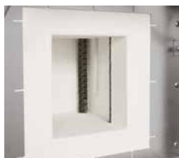
炉膛采用优质纤维材料，SiC加热棒位于炉两侧
