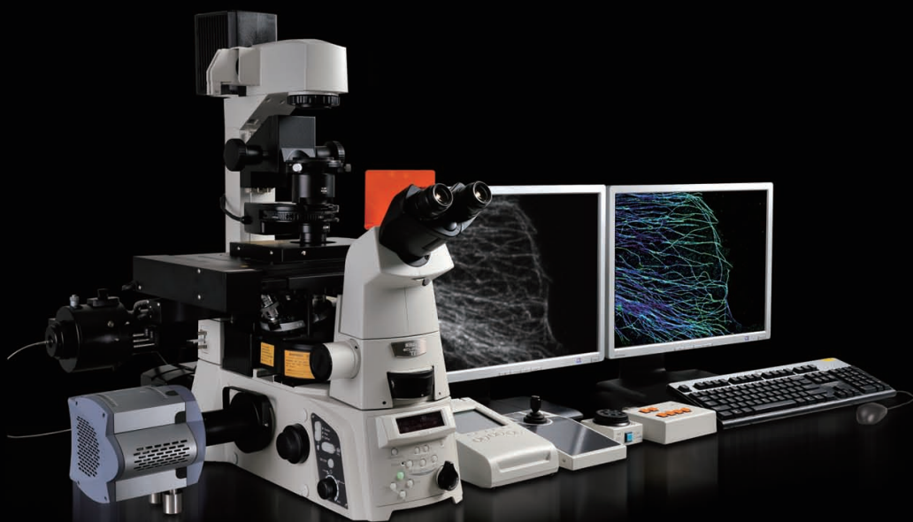
采用 Cyt3-Alexa647 染色的哺乳动物细胞微管束的单一色 3D-STORM 影像 物镜: CFI Apo TIRF 100x 油浸物镜 ( NA 1.49 ) Z 级: 50nm
