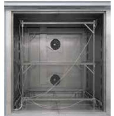
可插入式测试架用于空气循环箱式炉 N 7920/45 HAS 的测试
