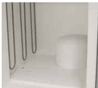
通过炉底进行充气的过程用罩保护炉膛免遭污染，或防止在批料和加热元件之间出现化学性相互作用
