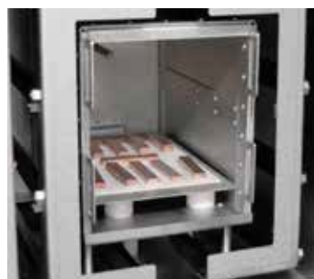
在氢气环境下，在 VHT 8/16-MO型罐式炉内对铜棒进行热处理
