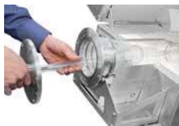
用于单侧封闭式石英玻璃管的气密密封塞
