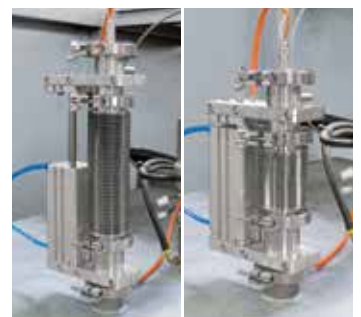
S 型热电偶，带有自动取出装置，确保了在较低温度范围内非常良好的控温效果
