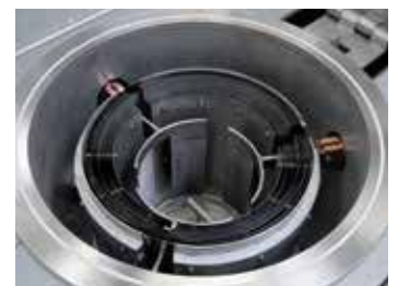
带钨丝加热装置的圆柱形气密罐
