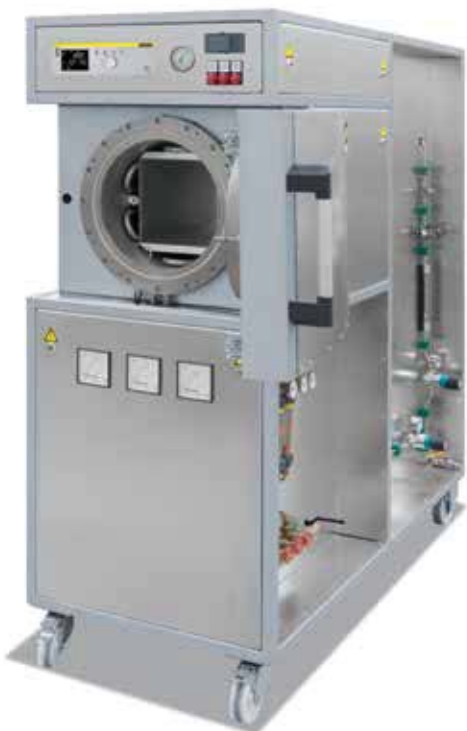
NRA 25/06 型罐式炉带有配气工序包
