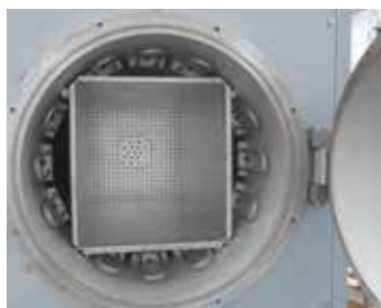
NRA .../06型罐式炉设有内置加热元件
