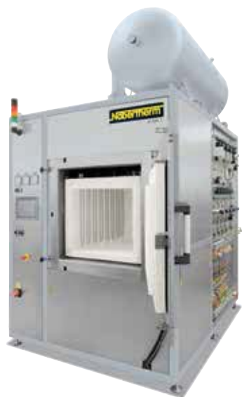
VHT 100/15-KE H 2 型罐式炉连同带有纤维保温层和扩展工序包，用于在氢气环境下运行，1500 °C
