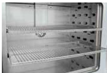
可拔出的格形栅板，用于在不同的装载层对干燥箱进行装载
