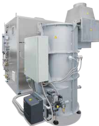
NR 150/11 IDB型罐式炉带热后燃烧系统
