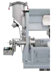
装填漏斗处装有振动发生器，用于更好地粉末导入
