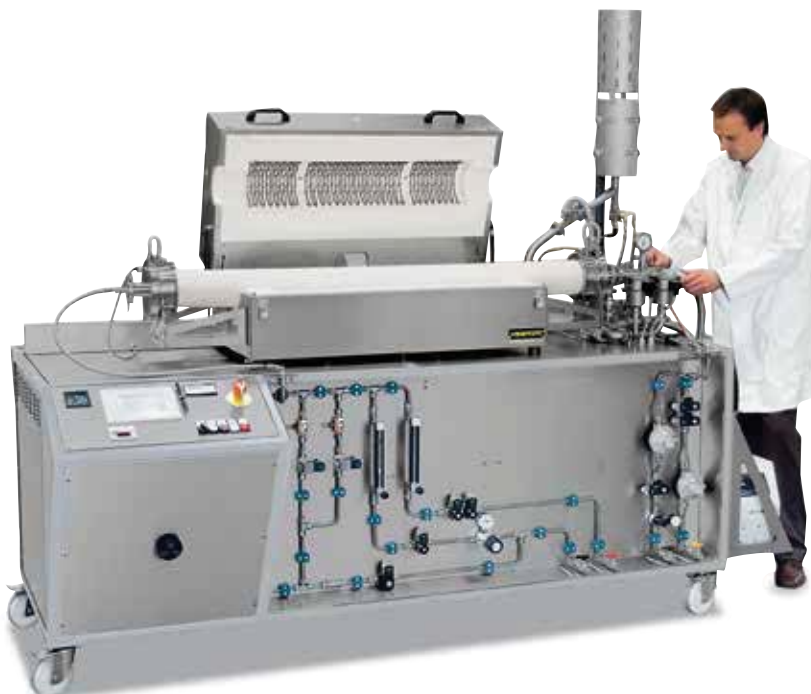
RSH 120/1000/11S型管式炉，三区控温，带隔板，以实现不同的温度梯度
