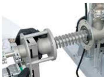
转速可调节式螺旋输送机
