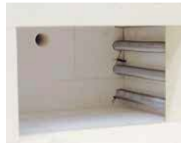
炉腔具备高级轻质耐火砖保温结构
