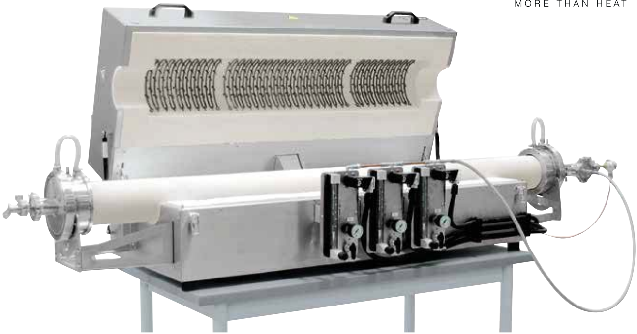
RS 120/1000/13S型管式炉，带气密管、安装在一个纤维模块中的加热元件、炉料控制装置和出口口上的止回阀
