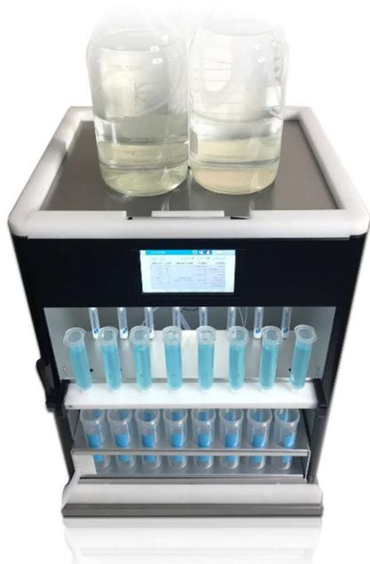
**SPE-03** 八通道固相萃取仪是一款应用范围广和样品处理速度快的全自动固相萃取仪。它既可以用于大体积水样品的萃取, 又可用于小体积样品提取液的净化(如食品中的农残、兽残分析, 土壤中污染物的分析, 法医学毒物分析)。它可以自动完成柱活化、平衡、预淋、萃取、吹干、洗脱、组份收集、和管路清洗等标准操作, 还具有梯度淋洗、双柱串联、和膜萃取等功能。由于采用了管路集成技术, SPE-03 结构大为简化, 重量只有 13 公斤, 所占实验室空间不到其它多通道固相萃取仪的一半。
