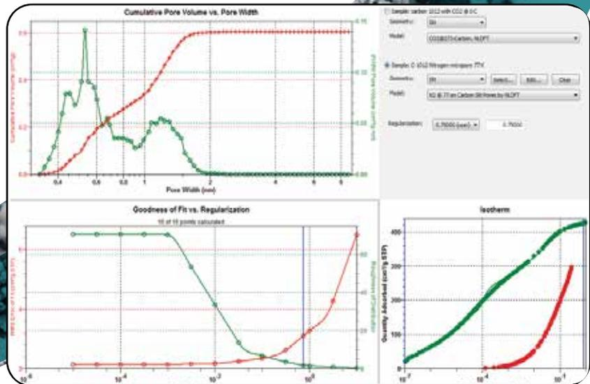
先进的NLDFT方法使用户能够使用两条等温线来确定样品的孔径分布。例如，二氧化碳在273K吸附等温线（红色），氮在77K吸附等温线（绿色）用于计算一个单一的孔径分布。用户无需剪切和黏贴氮和二氧化碳吸附数据—可以使用两个等温线获得单一的孔径分布。
