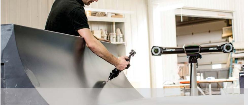
**HandyPROBE Next™** 便携式光学三坐标的测量精度不受环境不稳定因素的影响。无需固定的测量设置，部件、光学跟踪器和无线探头在测量过程中均可随时移动。系统专为车间应用而设计，具有无与伦比的灵活性，测量范围相对其他便携式 CMM 更广。
