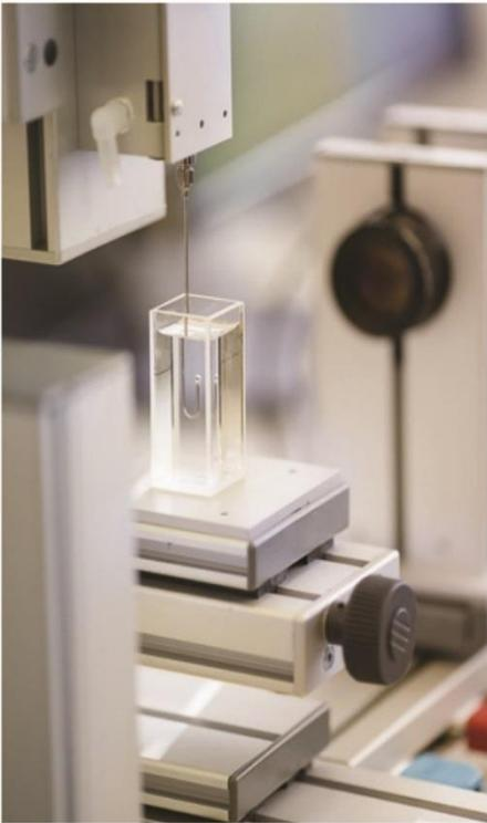
测量是基于液滴或者气泡形状分析。CCD相机获取滴或泡图像，软件同时分析给出结果。
