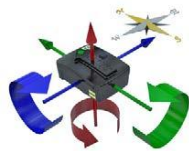
IM 肌电传感器 肌电、3D 加速度、陀螺仪、磁力计
