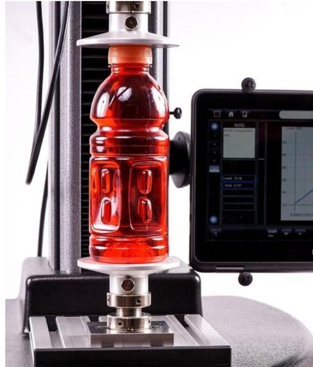
通过简单地输入测试类型、预载荷和极限来创建一个快速测试。
