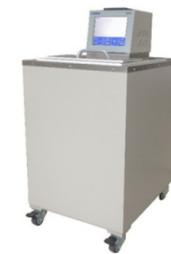
B系列温度标准槽的温度波动度优于 $0.01^{\circ}\text{C}$ ，温度均匀度优于 $0.01^{\circ}\text{C}$ ，适用于 $-30\sim 200^{\circ}\text{C}$ 的温度校准需求，自动优化最佳温度控制参数。设置双重防护，具有过温保护、低液位自动切断功能，操作简单，实验过程无需更换介质，适用于不同场合对温度校准的需求。
