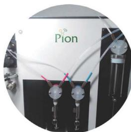
酸碱水高精度注射泵
