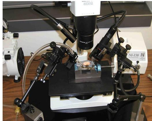
体式镜下的多功能微区取样仪和微细钻针 Milling bits, Bits 材质有高速钢、金刚石、碳合金、型号有 25um-3000um 之间进行选择；以上速度可达到 8000 rpm 每分钟的转速，属于超硬材料制成。
