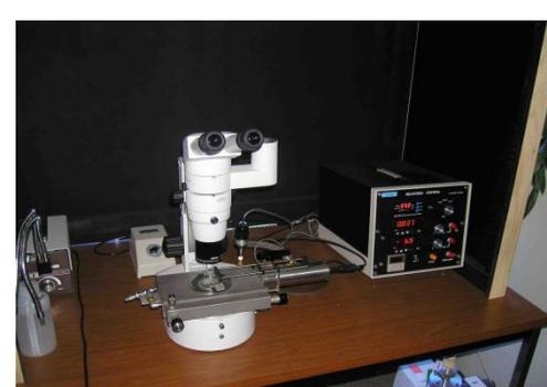
阴极发光仪是研究岩石矿物组分特征的一种快速简便的分析手段。该方法在快速准确判别石英碎屑的成因和方解石胶结物的生长组构、鉴定自生长石和自生石英以及描述胶结过程等方面得到了广泛的应用，可以深入了解砂岩的原始孔隙度和渗透率，并且获得一系列有关蚀源区地质体的组成、产状、成因的信息。
