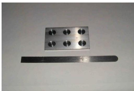
凹形观察窗可以减少工作距离，最小能够达到5-7 毫米范围，以供50X物镜自由转换使用。松散颗粒固定器用于放置松散颗粒状的样品。
