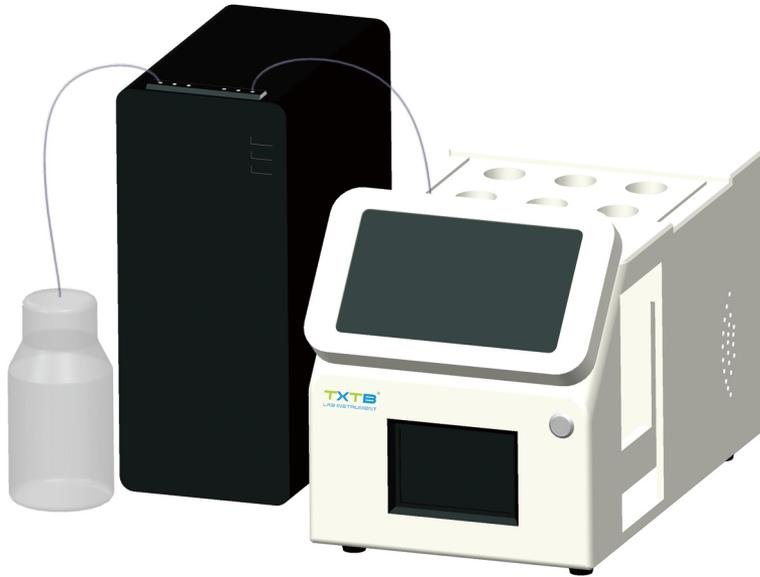
TRI-III全自动滴定系统采用全新的谱峰式终点判断方式以及精密的加液、馈液系统，实现批量样品自动化的滴定工作，采用全新的模块化的组合，客户可根据自身情况完成对不同自动化的定制和扩展，如增加自动进样模块，恒温模块以及前处理联机模块等，兼备了自动进样功能和自动滴定功能，该仪器适合多类型样品的滴定工作，满足PH滴定、脂肪酸值滴定、酸价滴定、COD滴定等用于颜色判断终点的分析实验。
