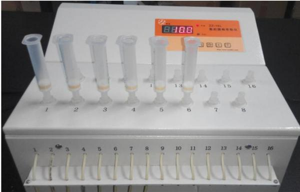
8、用移液器往固相萃取柱内分别加入溶液，按
