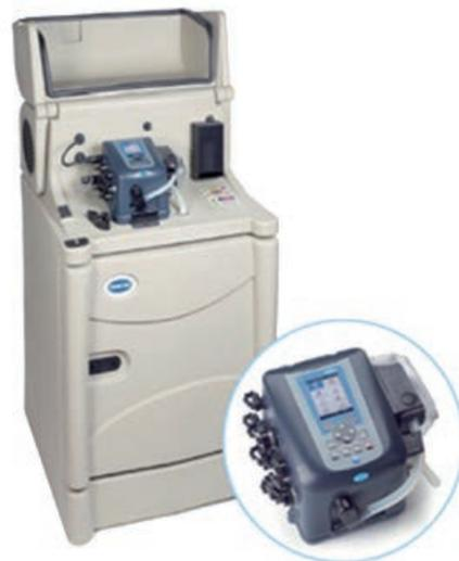
全天候冷藏采样器，能够保证水样的保存温度在4°C。压缩机放在了采样器的顶端，可避免硫化氢和其他比空气重的腐蚀性气体对其造成的损害。采样器配备的高强度、抗化学腐蚀的外罩，能更好地保护制冷管线不受潮湿和腐蚀性气体的侵害。系统的感应器通过对蒸发器的温度、环境空气的温度、样品液体的温度的连续监测，由微处理器控制水样室的升温。全天候冷藏式水质采样器提供的是对环境无害的、不含氟里昂的制冷剂。
