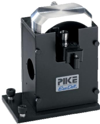
**UpIR**上置式漫反射附件既可用于粉末样品的测试，又适用于大样品的测试。是红外光谱法珠宝鉴定的必备附件。提供直径10, 7, 5, 3mm四种规格的样品挡板。
