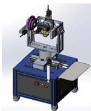
图 1 VR 延迟测试方案图
