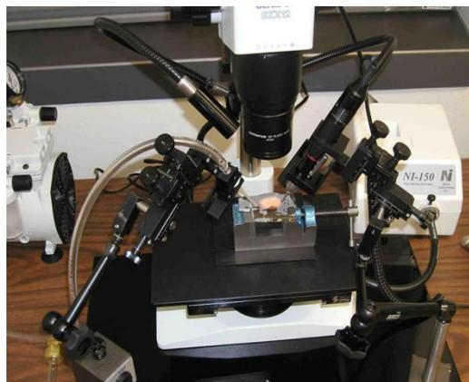
体式镜下的多功能微区取样仪和微细钻针 Milling bits, Bits 材质有高速钢、金刚石、碳合金、型号有 25um-3000um 之间进行选择；以上速度可达到 8000 rpm 每分钟的转速，属于超硬材料制成。
