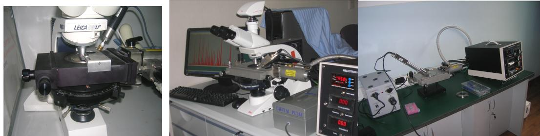
阴极发光上使用的能谱系统，基本的分析功能及其探测范围等都和其他的EDS系统相同，因为它们都依赖于电子光源。RELIOTRON阴极发光设备安装紧凑，同时可以与多种显微镜配套使用来观测阴极发光及EDS图谱，同时用来辅助对预定位置进行的分析，从而在样品测试时可以得到图像、谱线、数据更多信息。
