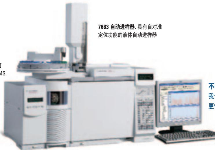
7683 自动进样器. 具有自对准定位功能的液体自动进样器
