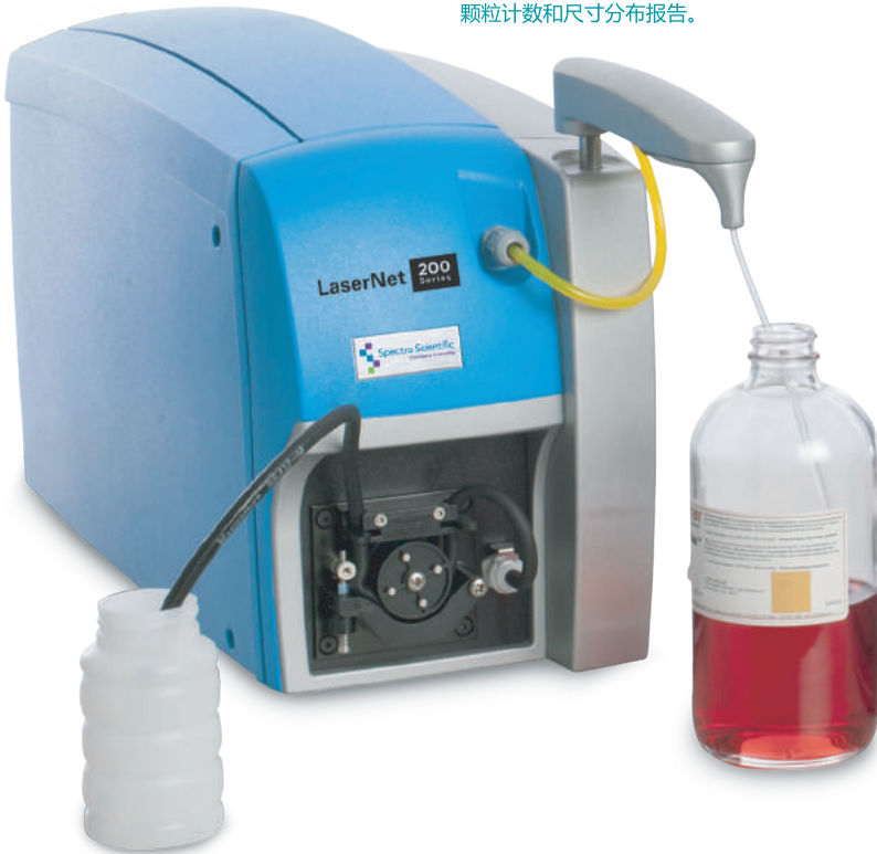
图像可直接在LaserNet 200软件中储存和分析。这些图像可通过磨损类型分类，OilView™软件也可得到磨粒颗粒计数和尺寸分布报告。
