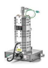
DLPI+ 收集颗粒物于 25mm 的收集膜上,可提供的膜包括铝膜和聚碳酸酯 膜。DLPI+可升级为实时在线型的 ELPI+,应用于实时在线分析。
