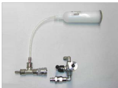
HEPA过滤器及三通
