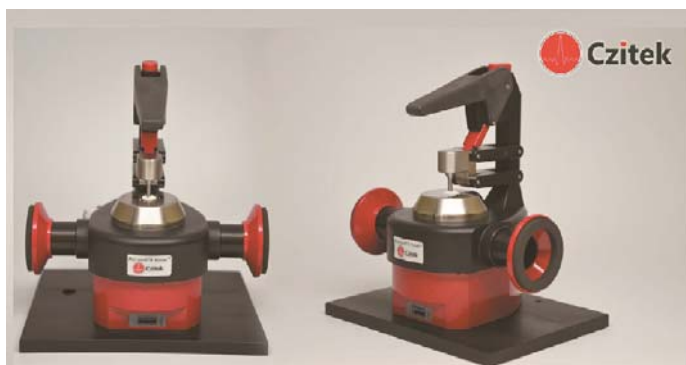
两种工作压头： 旋钮式和按压式
